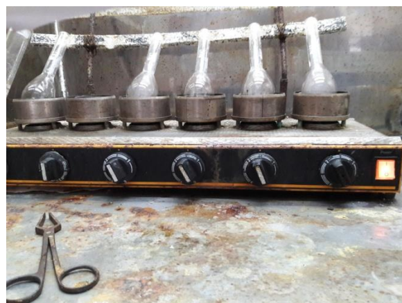
Gambar 2. Proses destruksi sampel protein menggunakan metode Kjeldahl
