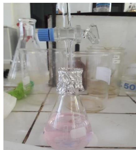
Gambar 4. Proses titrasi sampel menggunakan alat mikro Biuret
