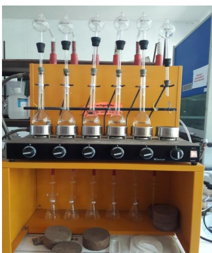
Gambar 3. Proses destilasi sampel menggunakan seperangkat alat destilasi Kjeldahl
